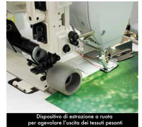
Dispositivo di estrazione a ruota per agevolare l'uscita dei tessuti pesanti
